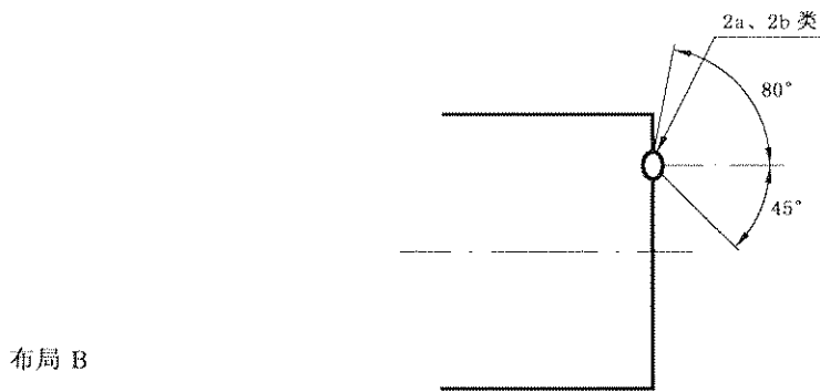
侧转向信号灯向后的可见度死角上限为 5°, d \leq 1.80\text{m} 。 (对于 M_1 和 N_1 类车辆 d \leq 2.50\text{m} )
